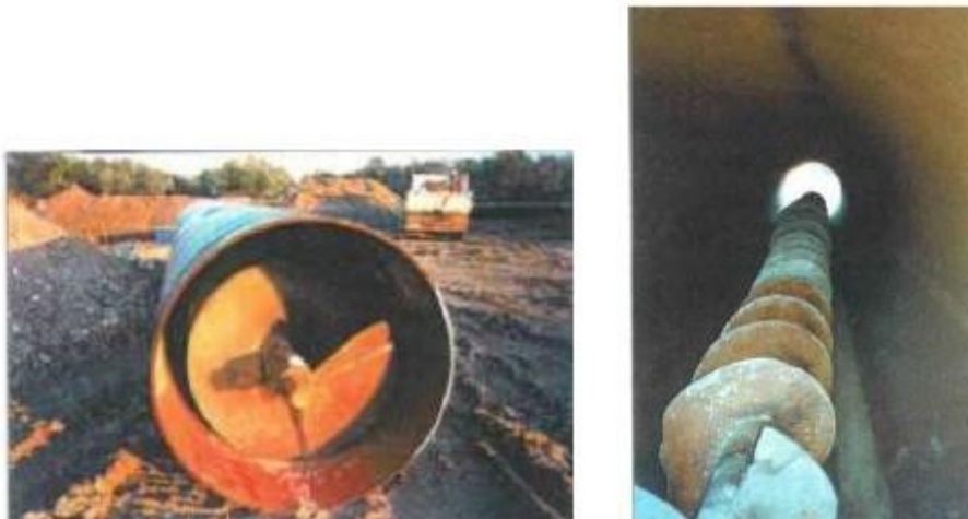
Figura 6-22 – Coclea di una spingitubo
