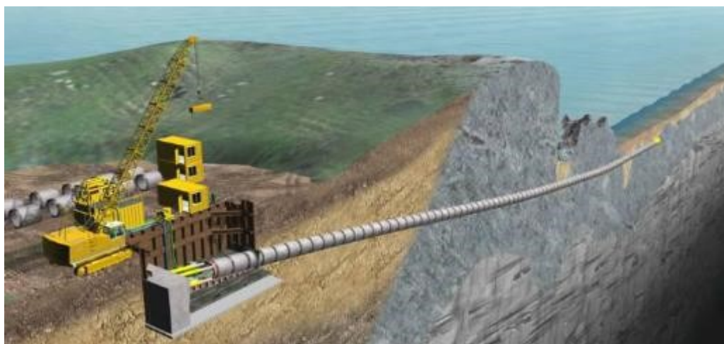
Figura 6-35 – Fase di scavo del microtunnel
