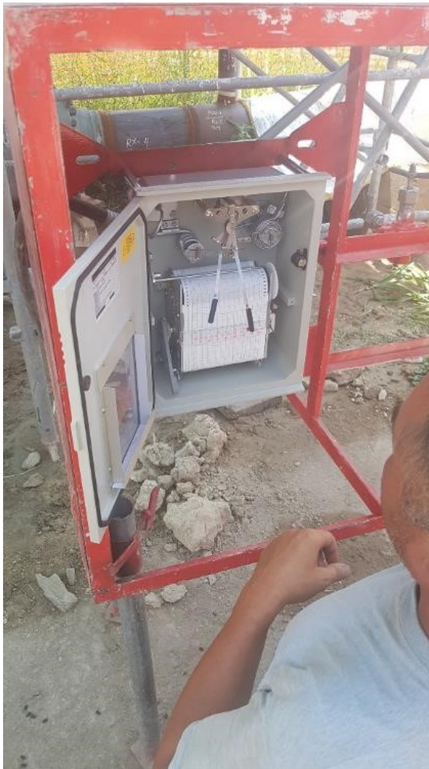
Figura 6-29 – Collaudo idraulico, manometro registratore
